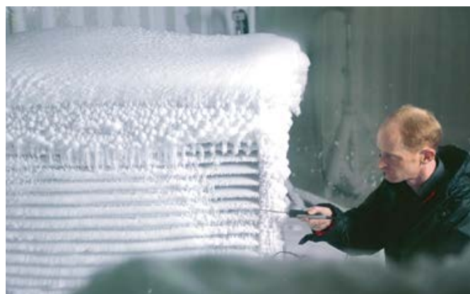
Komory klimatyczne symulują wszystkie potencjalne warunki eksploatacji
